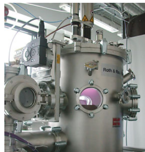
Abbildung 1: Apparatur PULVA-INP zur experimentellen Untersuchung von Plasma-Teilchen-Wechselwirkungen
